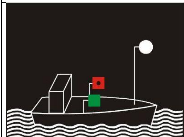
Рис. 59 Одинокные малые моторные суда: топовый огонь заменен ясным белым огнем, видимым со всех сторон.
